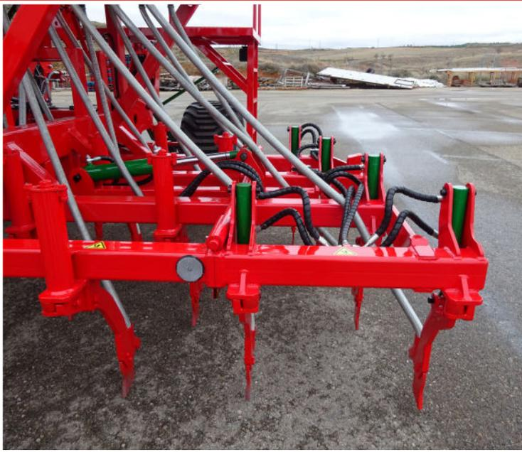
Las **alas** se despliegan, y las rejas se colocan en posición de siembra automáticamente al igual que las rastras. La fuerza de los **brazos** se regula por medio de sistema hidroneumático.
